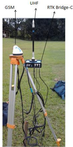
FIGURA 2. Utilização da repetidora (RTK Bridge-C) nos ensaios estático e cinemático
