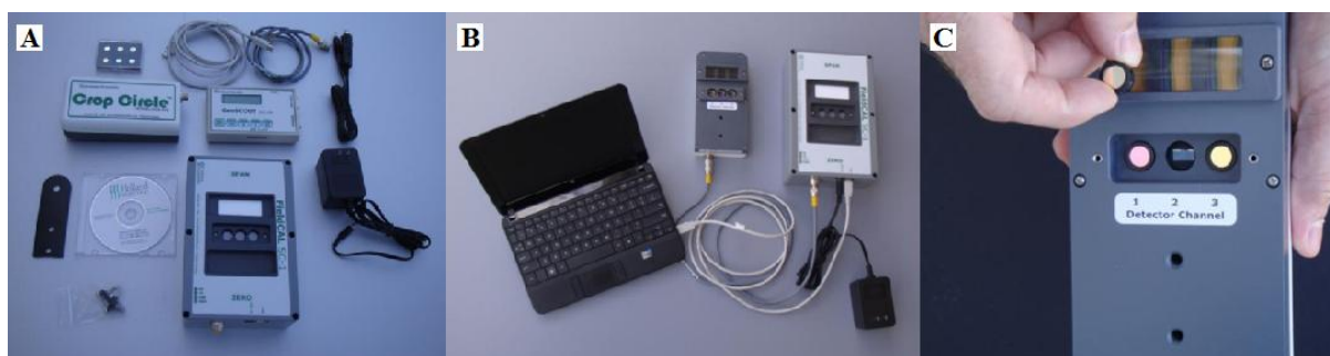
FIGURA 4. Componentes do sensor (A), sensor acoplado a computador para calibração (B) e troca de filtros óticos (C)
