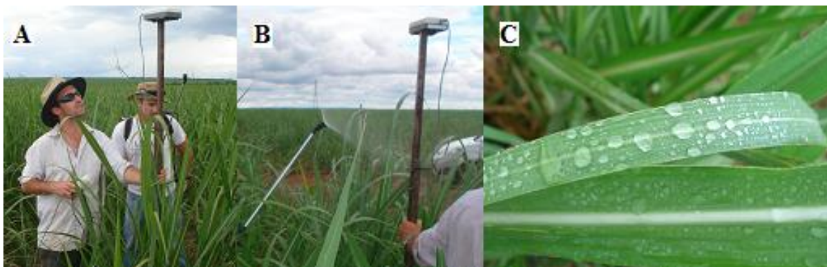
FIGURA 3. Coleta dos dados com o sensor antes (A) e durante (B) a simulação de chuva; destaque do molhamento das folhas após a simulação de chuva (C).
