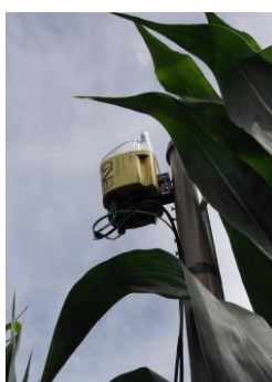
FIGURA 3 - Nó instalado em hastes a 2,7 m do solo.
