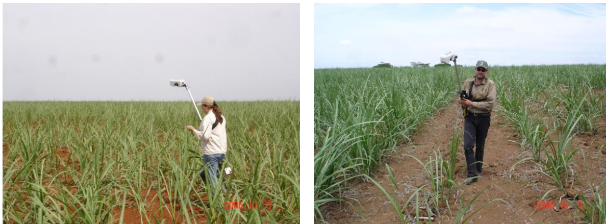
Figura 2: Leitura de NDVI com o sensor ativo.
